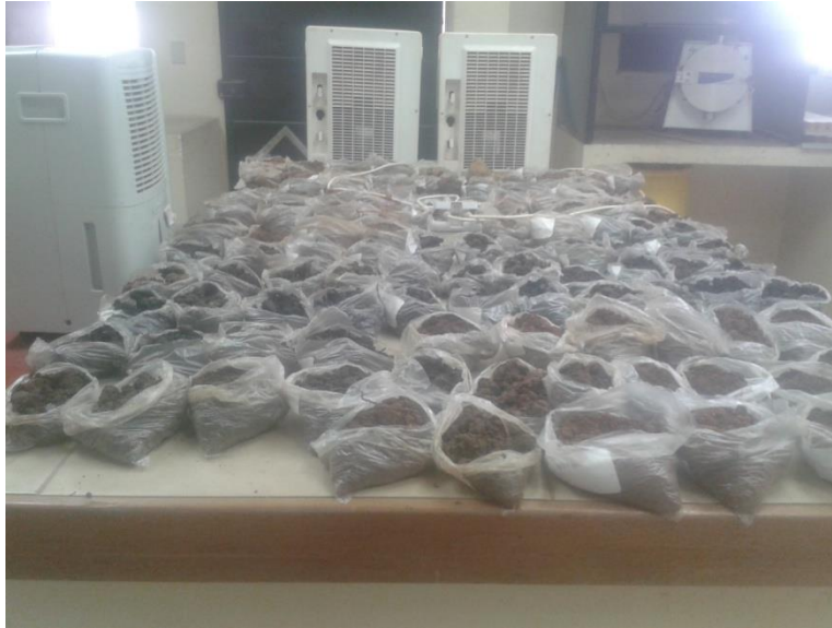
Figura 20: Muestras de suelo secándose al aire y deshumidificadores instalados.
