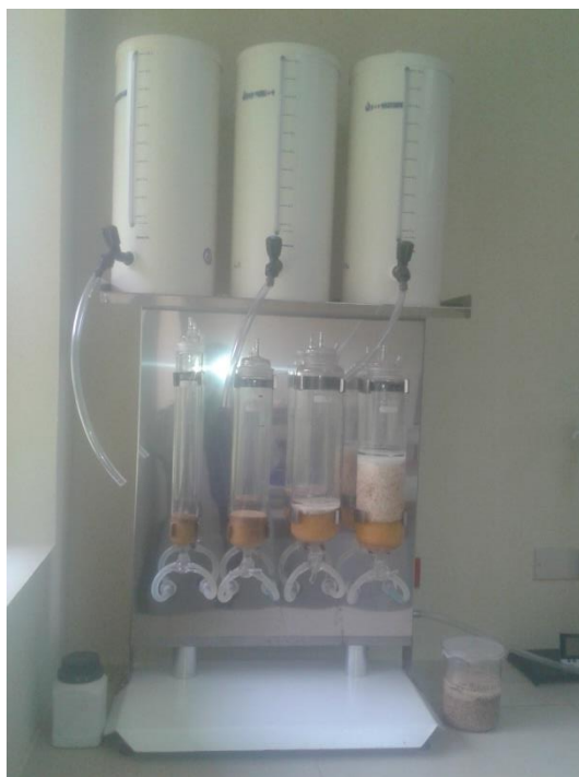
Figura 22 Equipo de preparación de resinas de intercambio iónico.
