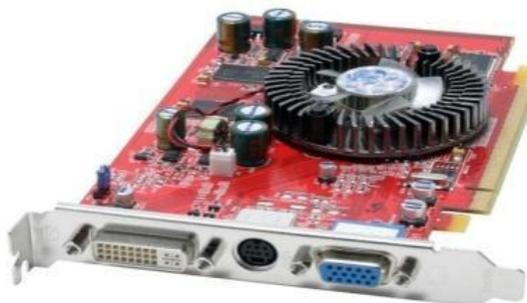
**Tarjeta de video, en la que se puede observar algunos puertos existentes para salida de video hacia un monitor o proyector.**
