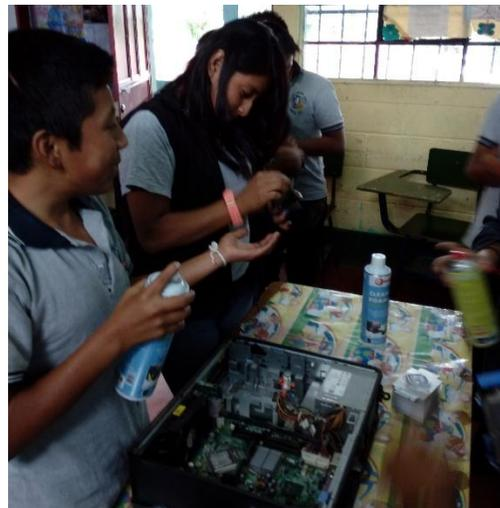
Aplicación de espuma a las partes que no contengan circuitos y limpia contactos a aquellas, que contengan circuitos, tales como RAM, tarjeta madre, ranuras.
