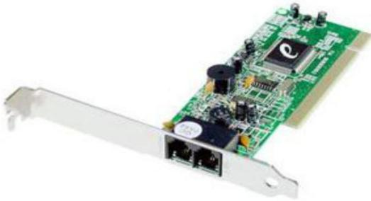
**Tarjeta de Fax-Modem para conectar directamente el teléfono o fax a la computadora.**
