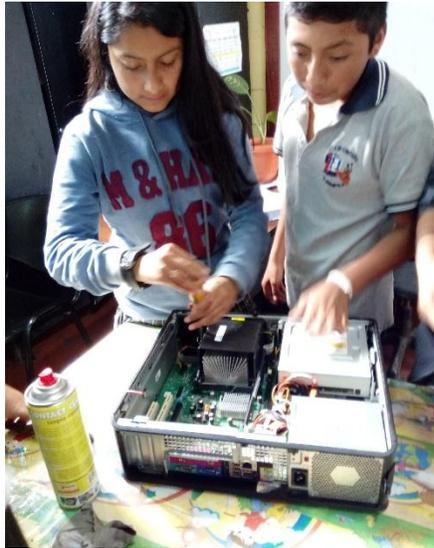
Retirando los tornillos del disipador.
