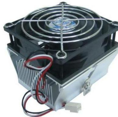
**Ventilador ubicado sobre una placa metálica llamada disipador** cuya función es mantener frío el microprocesador.
