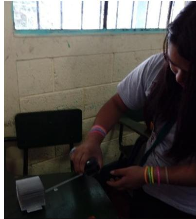
Aplicado de aire comprimido al disipador.
