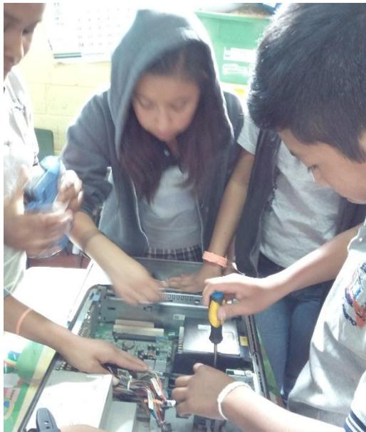
Atornillado de Disipador sobre el Microprocesador.
