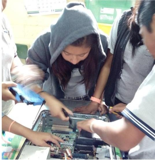
Colocación y atortillado de fuente de poder.
