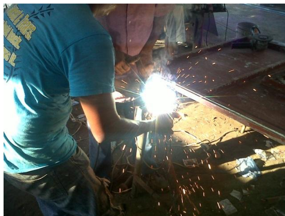
Soldadura del cuerpo del recipiente de basura
